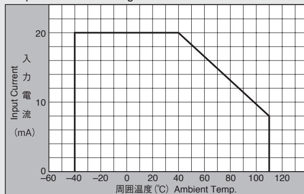
注)ホール素子の入力抵抗は周囲温度の上昇に伴い急速に低下します。使用温度範囲において最大入力電流を超えないように設計してください。
