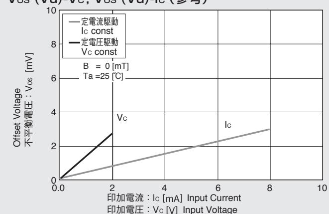
定電圧駆動  $R_{in}=354[\Omega]$ 、 $V_{os}=1.5[\text{mV}]$  [ $V_c=1[\text{V}]$ ] の例
