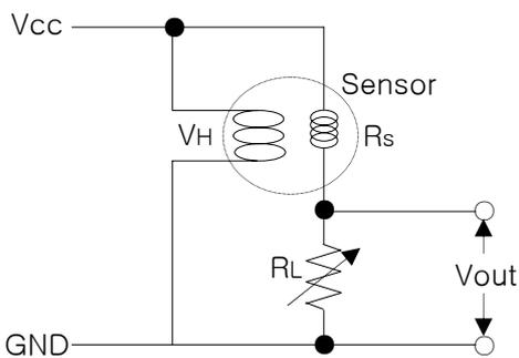
Vcc : Circuit Voltage(5V)    VH : Heater Voltage(5V)
