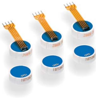
509 系列压力传感器芯片是基于由瑞士瑞士富巴公司自己开发的陶瓷技术。在过去的 15 年里已在上百万个工业项目中得到应用。设计可靠, 结构坚固, 从而保证了客户在装配时不会破坏压力传感器芯片的特性。该压力传感器芯片的输出信号是毫伏信号, 客户必须自己对信号进行处理。但零位输出信号已经作了校正。客户可自己决定是否自己作温度补偿处理。
