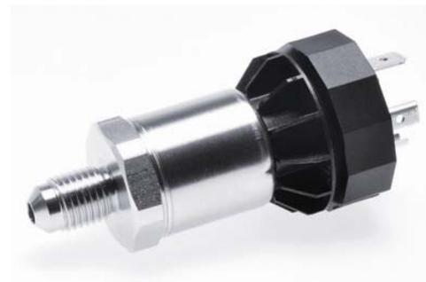
522 系列压力传感器采用公司自己研发的厚膜不锈钢芯片。适用于所有类型的工业控制介质，包括各种制冷剂以及阿莫尼亚(氨制冷剂)。不锈钢压力传感器芯片与外壳完全焊接联接。该系列压力传感器具有很强的抗电压脉冲的能力和抗电磁干扰能力。主要用于船舶工业。
