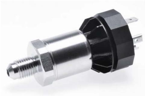
520 系列压力传感器采用公司自己研发的厚膜不锈钢芯片。适用于所有类型的工业控制介质，包括各种制冷剂以及阿莫尼亚(氨制冷剂)。不锈钢压力传感器芯片与外壳完全焊接联接。该系列压力传感器还有防爆规格，能满足各种工业使用要求。
