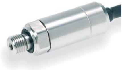
具有 IP69K 保护的 515 系列压力传感器配有 1.5 米的电缆和 HUBA 最新研发的厚膜混合技术陶瓷芯片。能满足所有工业制造和汽车制造的要求。结构紧凑，坚固。能适用于各种要求严格的应用场合。
