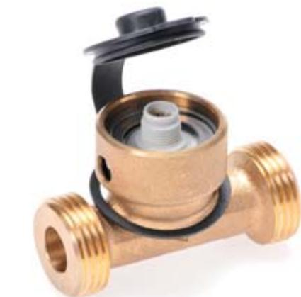
230 系列流量传感器的管体材料是红铜。作为选项，客户也可以选择温度测量附加功能。由于没有运动部件，此流量传感器对水质要求不高，压力损失小，精度高。
