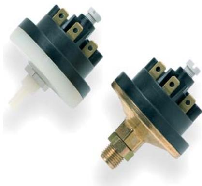
620 / 625 系列压力开关具有 13 档压力量程。适用于在通用工业设备中监控液体和气体。基体材料可以是塑料，黄铜和铝。隔膜材料有丁腈橡胶(NBR)，全氟橡胶(FPM)，三元乙丙橡胶(EPDM)和硅胶供选择。620 / 625 系列压力开关具有极高的工作精度和很好的长期稳定性。结构牢靠。特别适用于通用工业设备，加工技术和食品自动化。
