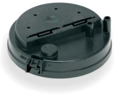
403 系列压力变送器用于空气/燃气混合比例控制系统中, 可以感应燃气压力的极微弱的变化. 采用的所有材料均与易燃气体兼容. 与 401 型压力变送器组合使用, 可以获得空气与燃气的最佳混合比例.
