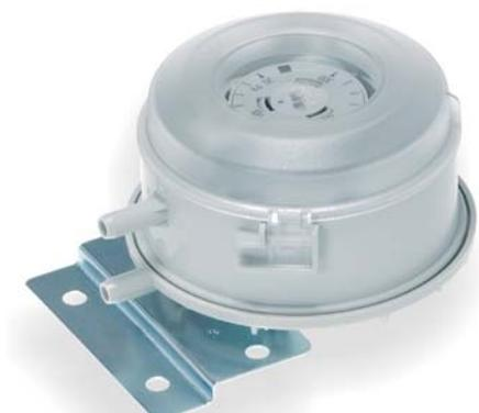
604 系列压力开关是在空调和通风系统中控制空气流量的理想产品。是高档楼宇控制系统必配产品。在工业空气监控应用中，如净化车间和实验室，灭菌柜，也得到广泛的应用。该产品系列具有 5 档压力量程。由于有组合支架，螺钉安装架和快速固定圈可供选择，非常易于安装。在每种压力范围内，开关压力还可根据实际情况按照压力刻度值作调整。调节精度高。
