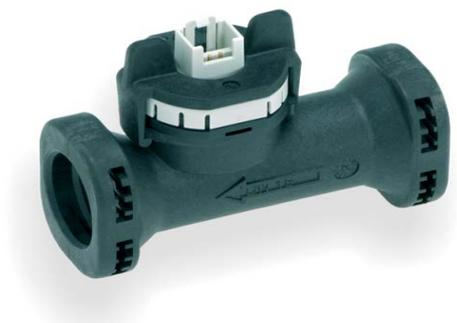
200 系列流量传感器是基于卡曼涡街(Karmen Vortex Trail)原理。作为选项，客户还可以选择温度测量附加功能。由于没有运动部件，此流量传感器对水质要求不高，压力损失小，精度高。
