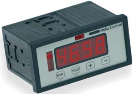
800 系列数字显示器配有一个 4 位数字显示屏。并可选择开关和模拟量输出。数字显示屏上显示的是把压力传感器的输出信号转换的压力单位。而压力量程最大值的设定可通过面板前的按钮来完成或把 800 系列数字显示器用数据线与计算机相联，从而通过计算机来设定。
