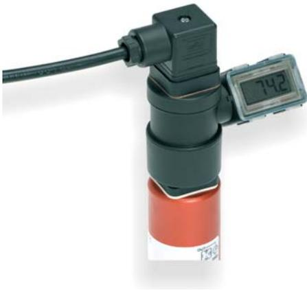
801 系列数字显示器可用于所有配有 DIN EN 175301-803-A 插头的压力传感器。无论传感器安装位置如何，显示器均可旋转至最佳读数位置。配有 3 位数字的液晶显示屏。
