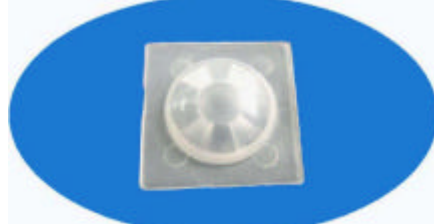
型号：8307-3 焦距：12 角度：90° 距离：6m 尺寸：21*21 厚度:0.6
