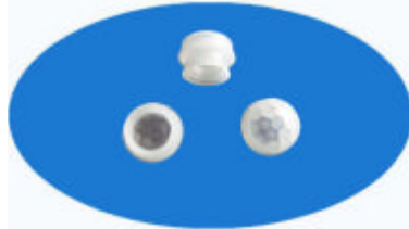
型号：8120-5 焦距：6.0 角度：120° 距离：5m 尺寸：12.5 高度:10.45
