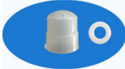
型号：8308-6 焦距：9.0 角度：120° 距离：9m 尺寸：12.4(13.4) 高度：15.5
