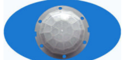
型号：8604-2 焦距：18 角度：120° 距离：10m 尺寸：内径36.0 外径43.5
