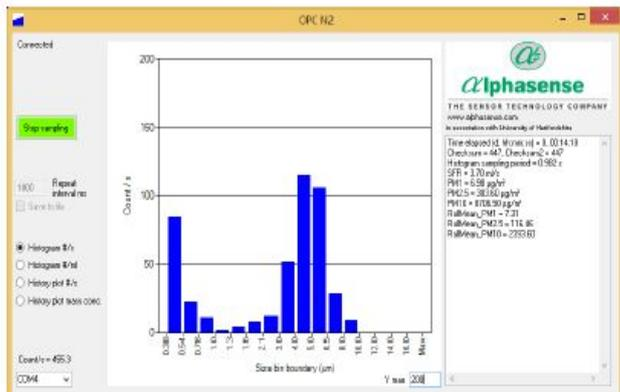
图3显示了用标定气溶胶校准时，OPC-N2检测到微粒尺寸分布图。
