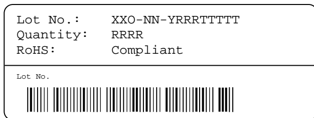
图 20: 卷轴上的标签: XX = 传感器型号 (21 for SHT21), O = 输出方式 (D = Digital, P = PWM, S = SDM), NN = 芯片版本, Y = 年的最后一位, RRR = 卷轴上的传感器数量除以 10 (通常为 200 或 2000)。TTTTT = 追踪代码。
