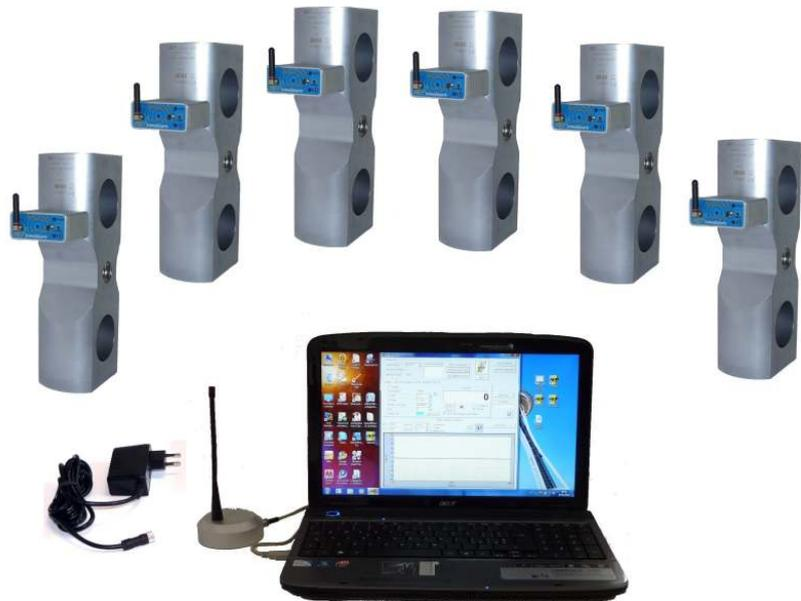
Il trasmettitore wireless WIMOD è un modulo radio che applicato su diversi modelli di celle di carico consente di interfacciare fino a 32 celle ad un unico PC di controllo.
